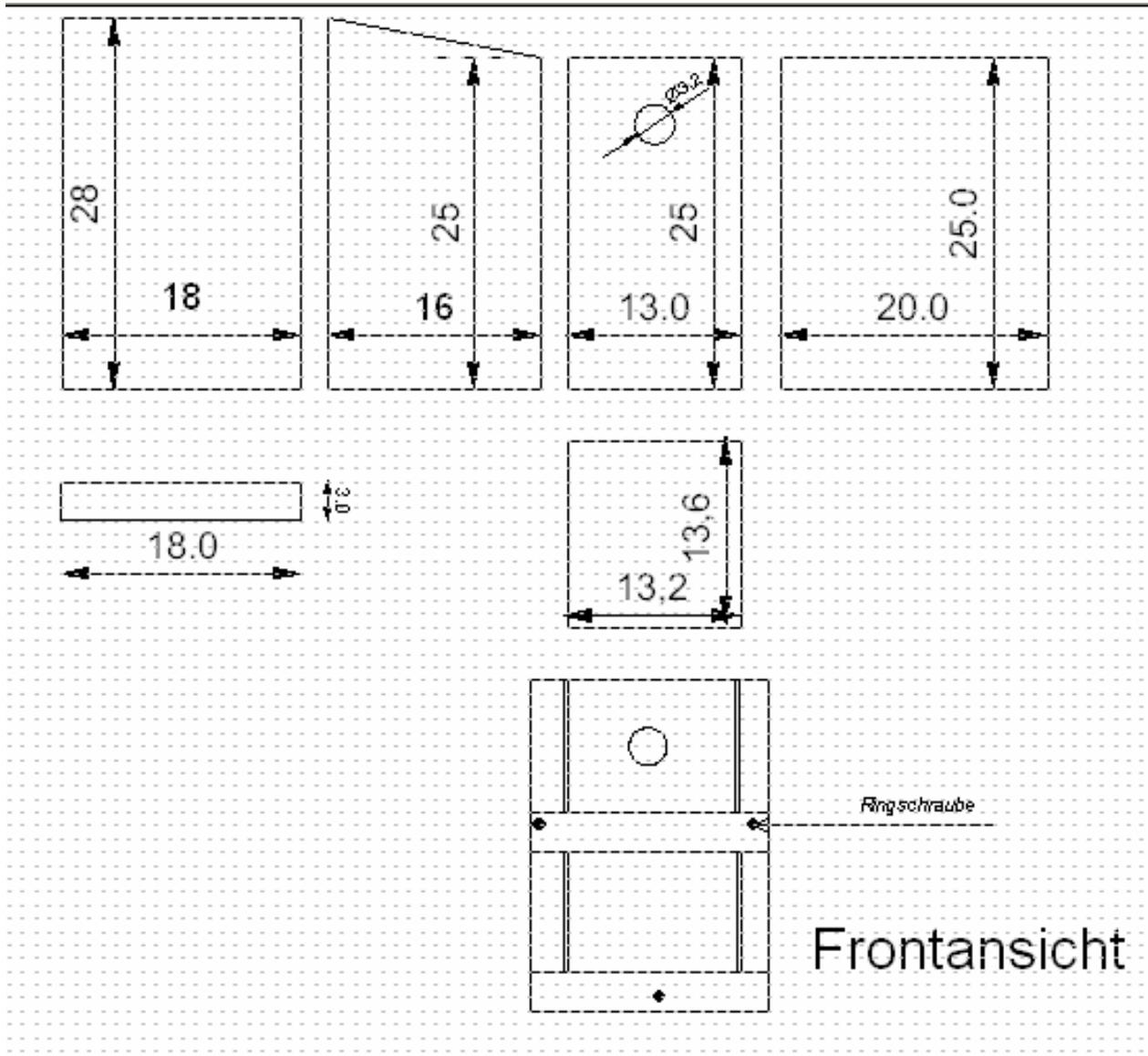
Die Zeichnung ist auf der Grundlage von ungehobelten Fichtenbrettern mit einer Materialstärke von 24 mm gefertigt. Achtung: kein glattes Material verwenden!
