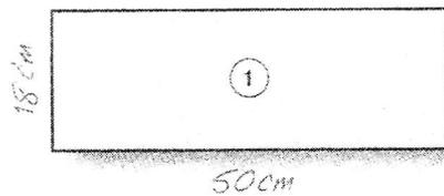
Seitenwände und Zwischenwände (4x)
